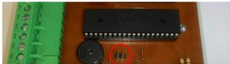
Установка (снятие) джампера Джампер снят
